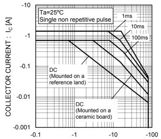
COLLECTOR TO EMITTER VOLTAGE :  $V_{CE}[V]$
